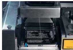
一个步骤实现激光快速打刻和标签裁切，最大化地提高生产效率，而且标签内容和尺寸设计灵活。
